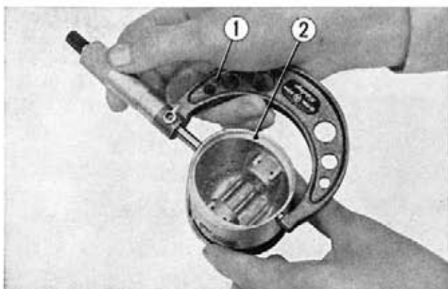
Fig. 3-61 ① Micrometer ② Piston
