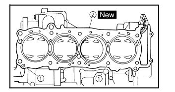
INSTALLING THE CYLINDER HEAD
