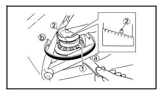
ADJUSTING THE REAR SHOCK ABSORBER ASSEMBLY
